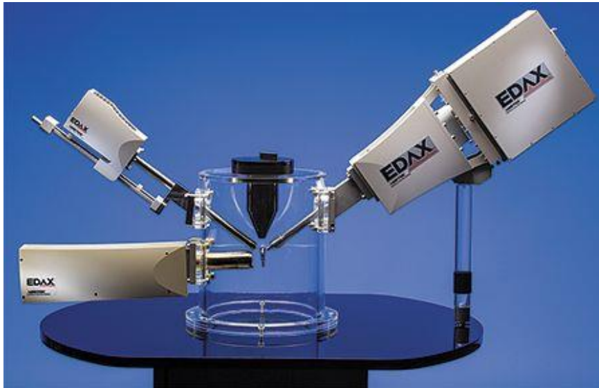
Fig: 2.6 Instrumental setup of EDS
